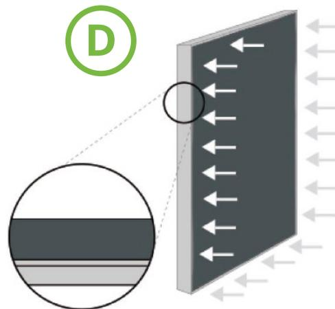
Work outwards towards the corners while continuing to press downwards on the silicone edging. To avoid stretching, creasing at the edges and dirtying the graphic, do not wipe your hands across the image. Puis se diriger vers les extrêmités par petits appuis. Ne pas faire glisser les doigts sur le visuel.
